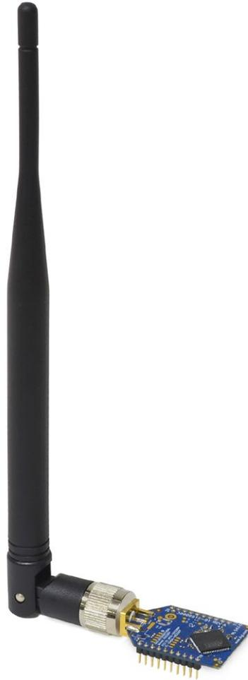
Figure : XBee 900MHz
